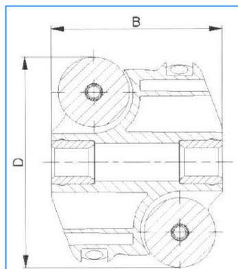
Galets équipés d'olives plastique roulant sur des axes inox
